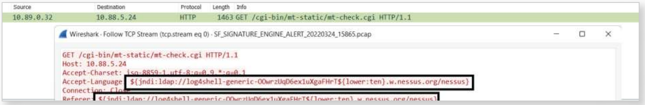
Ekli PCAP IP 192.168.0.32, Log4j / Log4Shell güvenlik açığını kullanarak 10.88.5.24'e saldırıldığını gösteriyor
